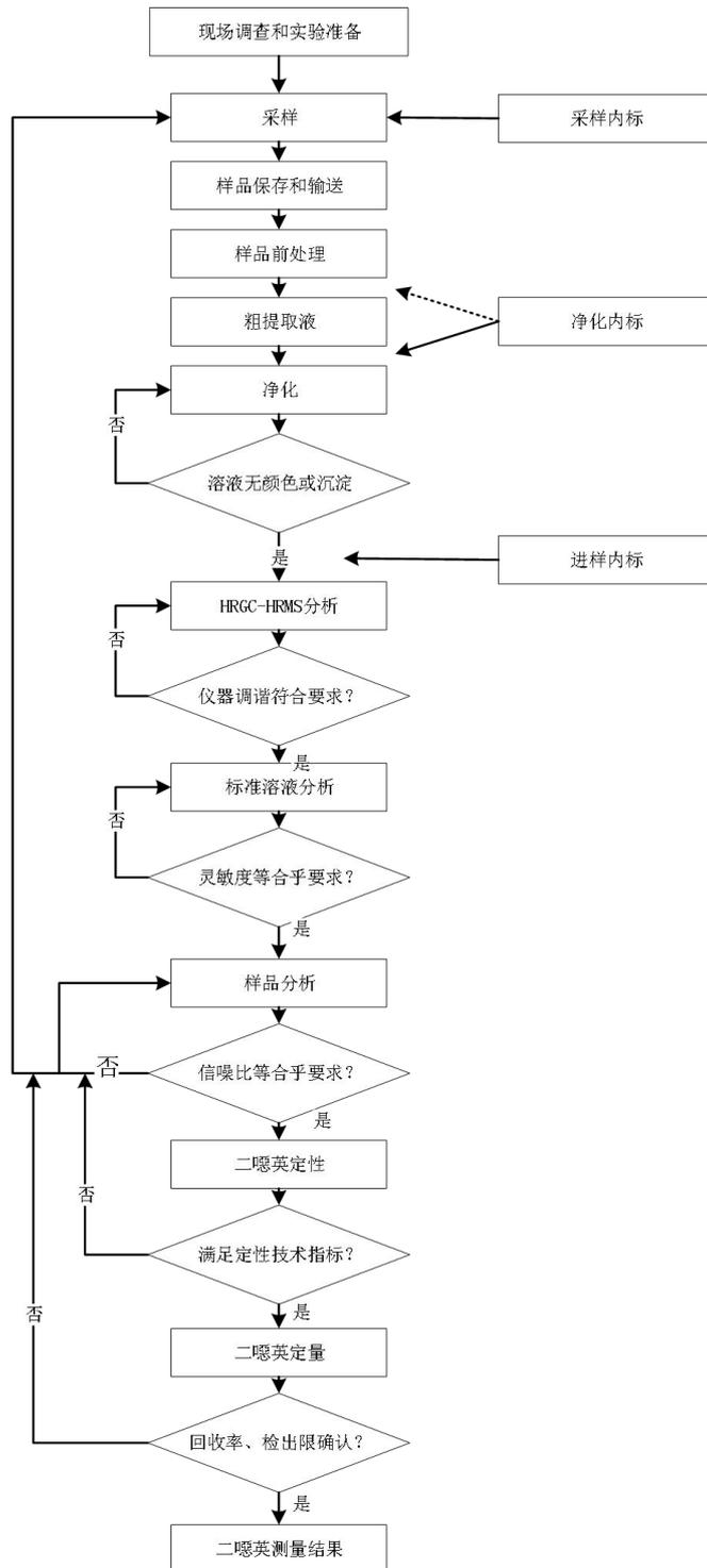
图 C.1 二噁英类监测基本流程图
